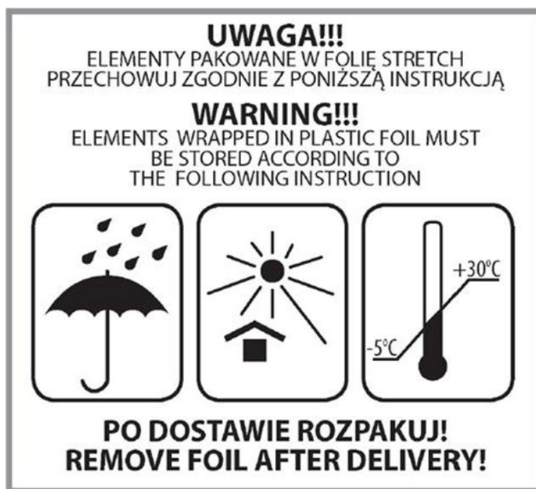
Rys. 3 Wytyczne do składowania profili krawędziowych zgodnie z naklejką nanoszona na opakowanie z profilami.
